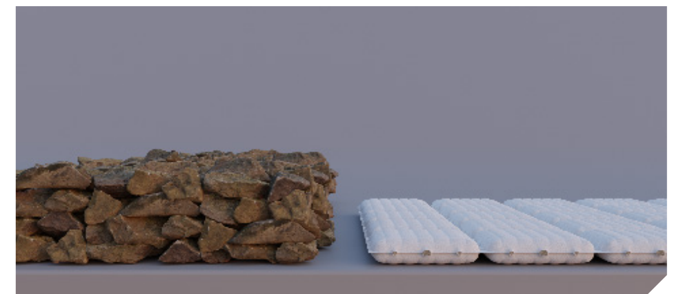
Espesor correspondiente para roca vs Colchón de Concreto Encapsulado
