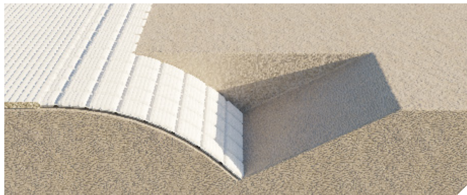
Técnica de zanja de base de inicio automático
